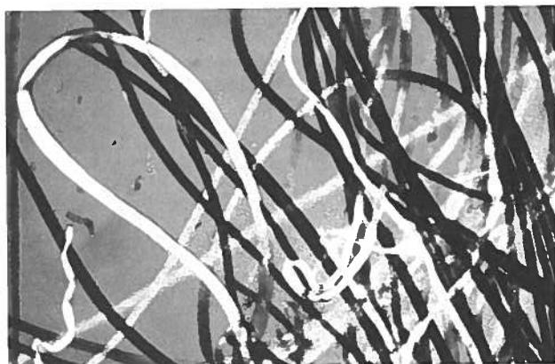
Fig. 7 – Fibras de lã (a preto na fotografia e na preparação coradas de azul pelo método do ácido perbórmico-azul alciano) e de poliéster (birrefringentes e não coradas) analisadas em luz polarizada.
