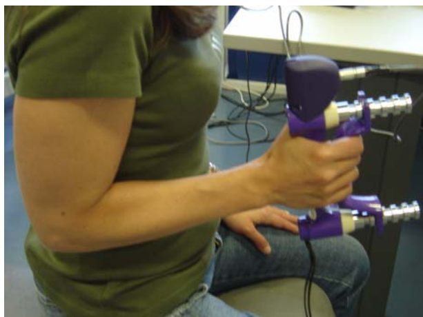
Fig. 1 – Dinamómetro Biometrics E-Link e posição de teste para força de preensão ( peak force )
